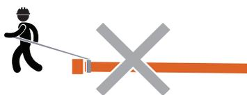
● При выполнении погрузочно-разгрузочных работ применяются мягкие стропы из полимерных материалов или мягкие монтажные полотенца, не оставляющие дефектов на трубах.
