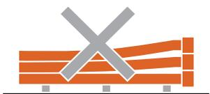
● Хранение труб производится на плоской площадке, очищенной от камней и острых предметов. При складировании труб принимают меры против их самопроизвольного раскатывания.
