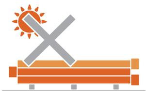
● Следует принять все необходимые меры для предотвращения повреждения торцов и наружной поверхности труб. При необходимости осуществить прокладывание досок с упорами между рядами труб.
